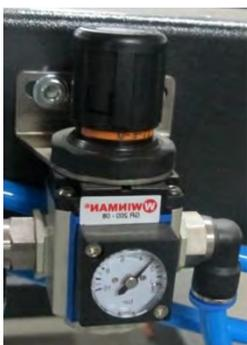
**Régulateurs de réglage de pression:** La pression de serrage peut être réglée en fonction de la finesse du profil.
